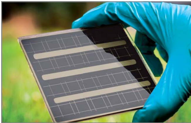
Dünnschicht-Solarzellen, wie sie vom Fraunhofer FEP und von der CTF Solar GmbH in einem Forschungsprojekt entwickelt werden sollen, versprechen niedrigere Herstellungskosten und einen höheren Wirkungsgrad. | © Fraunhofer FEP
