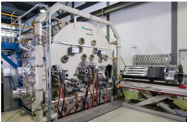
**coFlex® 600 – Rolle-zu-Rolle-Pilotbandbeschichtungsanlage am Fraunhofer FEP**
