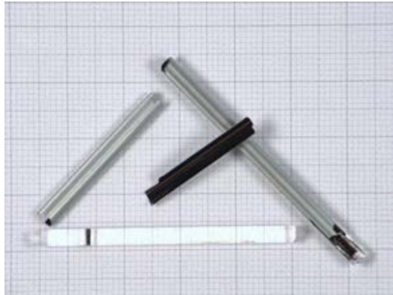
Vom Glasstab abgelöstes Mo-Röhrchen und Halbschale mit Interface-Schicht
