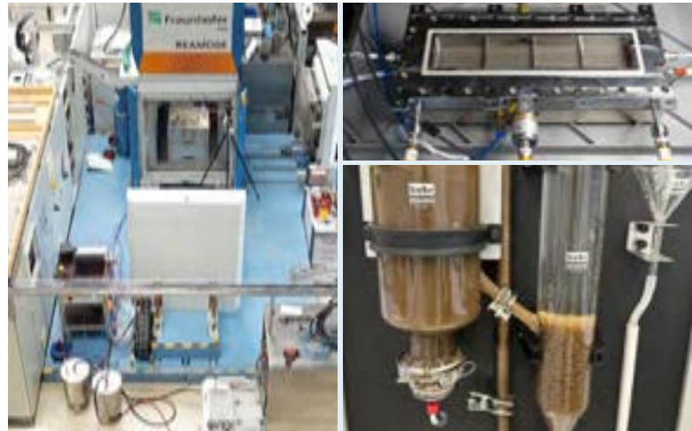
Integration des ARA-Moduls zur kombinierten Behandlung von Flüssigkeiten mit niederenergetischen Elektronen und Ozon (rechts oben) in die Laboranlage REAMODE (links). Simulation der biologischen Abbaubarkeit der Transformationsprodukte in einer Laborkläranlage (rechts unten).
