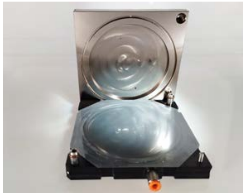
WVTR-Permeationszelle mit einer beschichteten Polymerfolie
