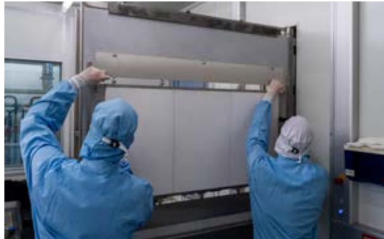
E-Chuck-Transfer des dreiteiligen elektrostatischen Chuck-systems für 600 × 1200 mm 2 Substrate auf den Carrier der vertikalen in-line Beschichtungsanlage
