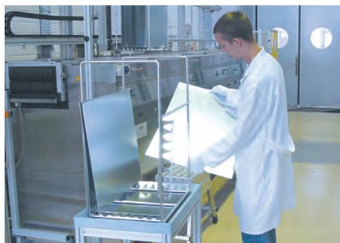
Ein Hauptarbeitsgebiet des Fraunhofer FEP ist die Entwicklung von Beschichtungen, um verschiedensten Grundmaterialien neue oder verbesserte Funktionen zu verleihen. Eine abgestimmte Reinigungstechnologie im Vorfeld der Beschichtungsverfahren ist dabei essenziell, damit die Schichtsysteme haftfest aufgebracht werden können.
