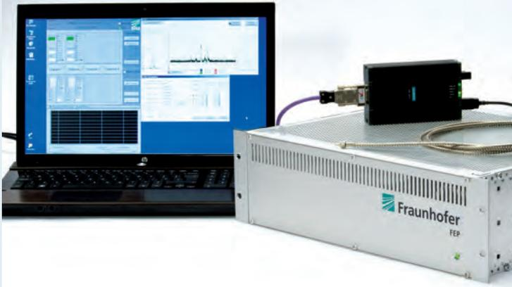
S-PCU (Spectrometer-Process Control Unit) zur aktiven Stabilisierung und Plasmadiagnose reaktiver Sputterprozesse
