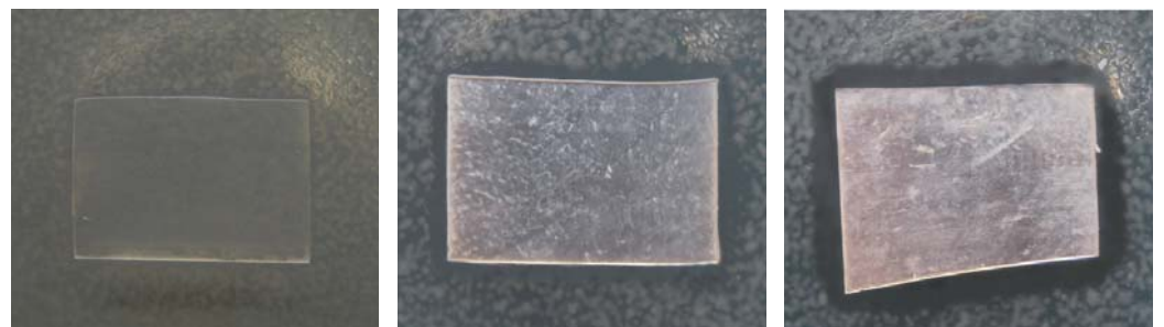
Abb. 14: Agardiffusionstest mit beschichtetem Polyurethan; Links: kein Hemmhof um unbeschichtetes PUR; Mitte: Hemmhof um 50 % Ag / 50 % Cu-Beschichtung; Rechts: Hemmhof um 100 % Ag-Beschichtung
