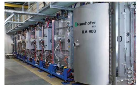
Abb. 3: In-line Sputteranlage ILA 900 des Fraunhofer FEP
