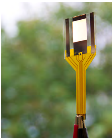
Kontaktierte OLED auf Dünnglas
