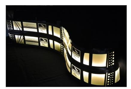
Flexible OLED benötigen eine wirksame und gleichzeitig preiswerte Verkapselungsfolie um eine lange Gebrauchsdauer zu ermöglichen. Die Entwicklung flexibler OLED zusammen mit den Verkapselungslösungen ist ein Entwicklungsschwerpunkt des Fraunhofer FEP. Die atmoFlex-Anlage ist ein wichtiges Werkzeug zur Entwicklung solcher Verkapselungsfolien.
