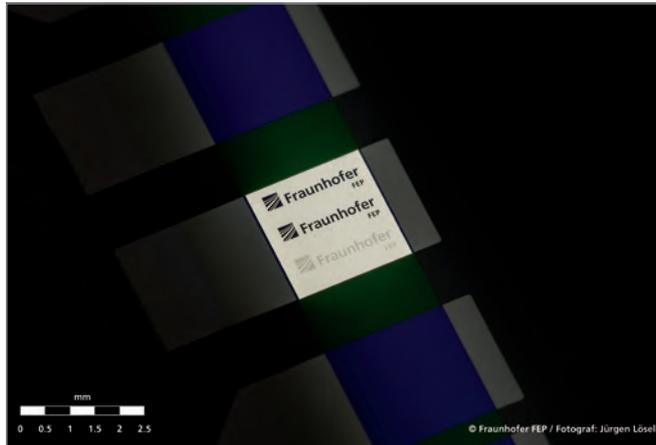
**Mit Elektronenstrahl strukturierte OLED**
