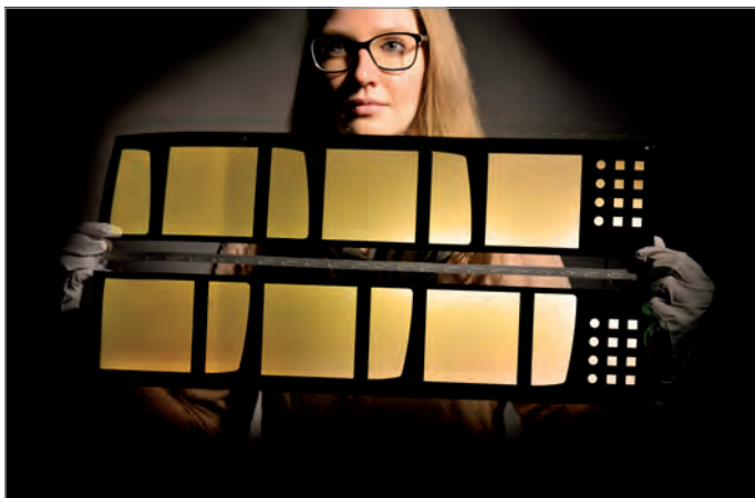
Glas-auf-Glas laminierte OLED hergestellt auf der Rolle-zu-Rolle-OLED-Prozesslinie am Fraunhofer FEP
