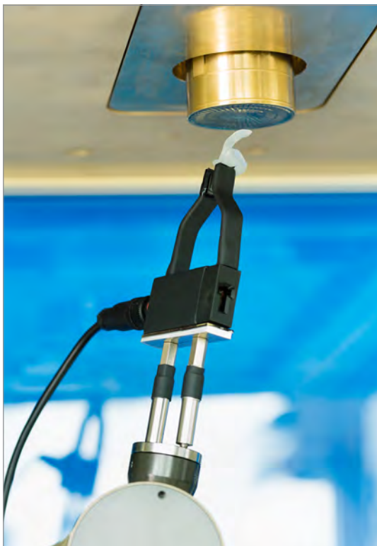
Austrittsfenster des Miniaturelektronenstrahlers und Roboterhandling zur 3D-Elektronenstrahlbehandlung
