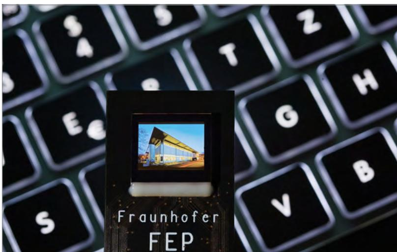
**Vollfarbiges SVGA-OLED-Mikrodisplay mit integrierter Bildsensorfunktion**
