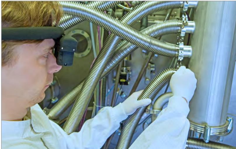
**Interaktive, blickgesteuerte Datenbrille mit vollfarbigen OLED-Mikrodisplays im industriellen Einsatz**
