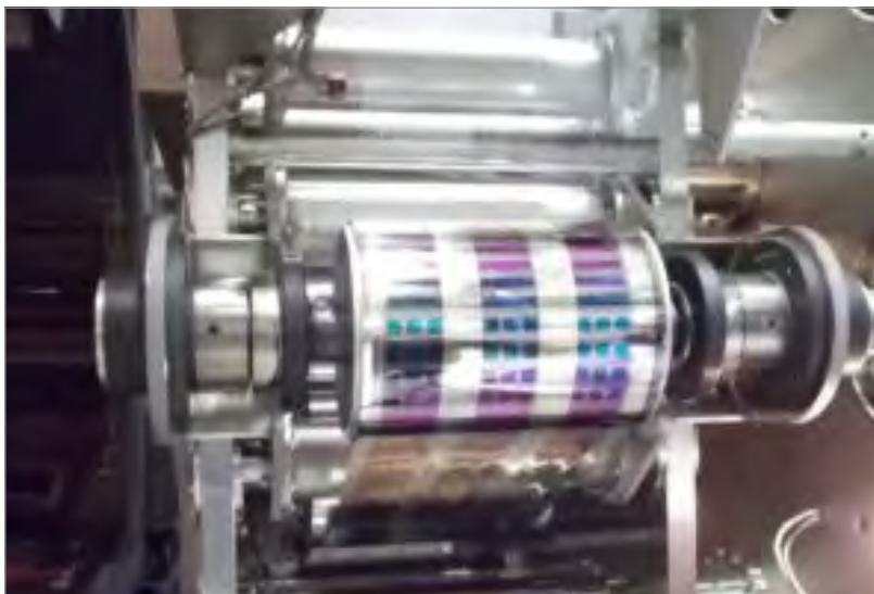
Detailansicht der Rolle-zu-Rolle Vakuumanlage am Fraunhofer FEP
