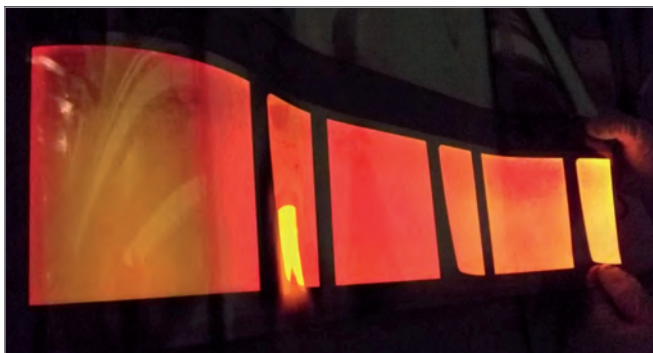
Bild 2: Flexible OLED hergestellt am Fraunhofer FEP im Rolle-zu-Rolle-Verfahren
