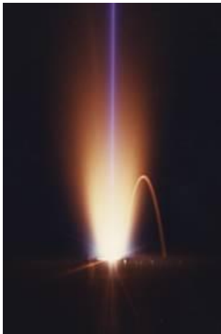
Elektronenstrahl beim Schweißen
