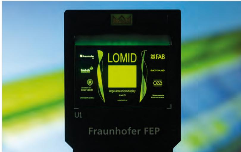
**Erster Testchip des LOMID Projektes mit einer Displaydiagonale von 2,5 cm und Auflösung von 1920 x 1200 (WUXGA)**
