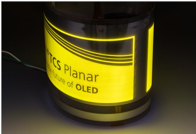
**Flexible OLED hergestellt im Rolle-zu-Rolle Verfahren auf SEFAR TCS Planar Substraten**
