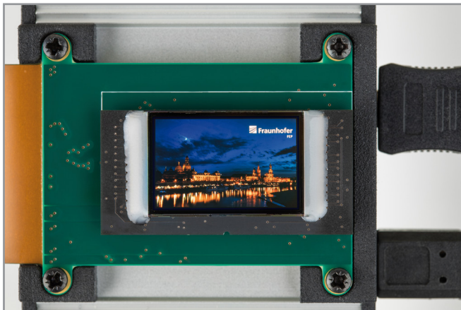
Dank eines ausgeklügelten Systemkonzepts und moderner Designmethodik erzielt das neue OLED-Mikrodisplay eine Auflösung von 1920 x 1200 Pixel
