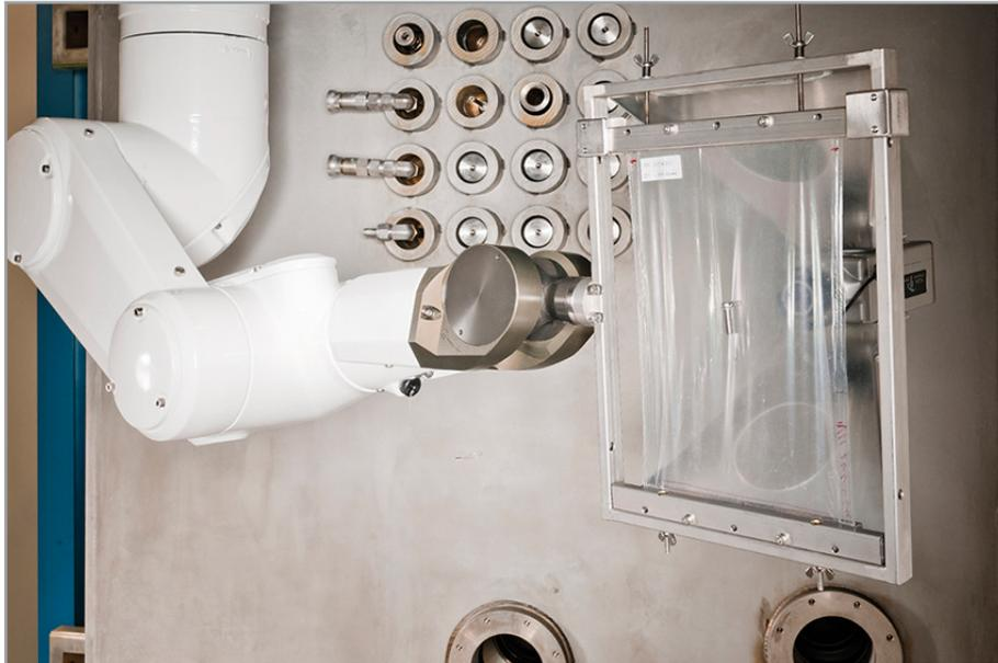
**Sterilisation einer Implantatschraube mittels Elektronenstrahltechnologie und 3D-Handling**
