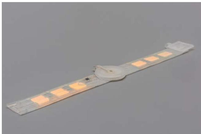
**Armband mit flexiblen OLED**
