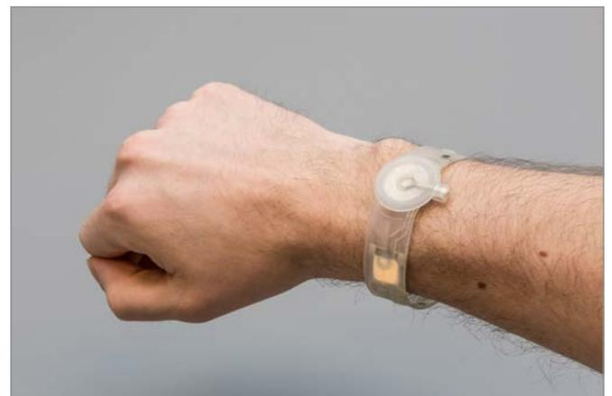
**Armband mit flexiblen OLED**
