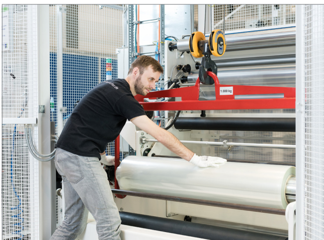
1,25 Meter breites Foliensubstrat an der Rolle-zu-Rolle-Beschichtungsanlage atmoFlex 1250
