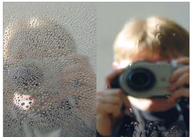
Superhydrophile Titandioxid-Schicht (rechts) als easy-to-clean Beschichtung
