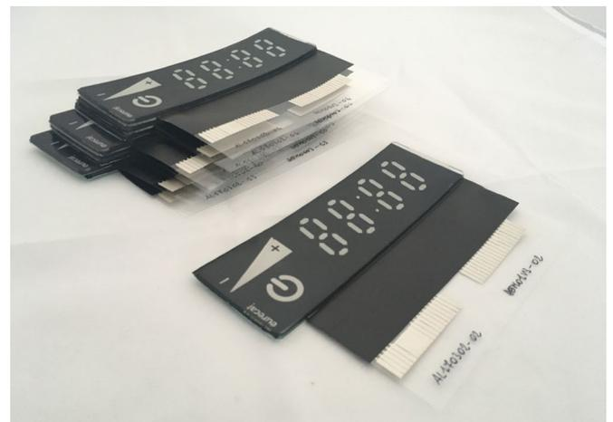
**Spritzgusselektronik, funktionale Kunststoffbauteile mit integrierter gedruckter Elektronik**
