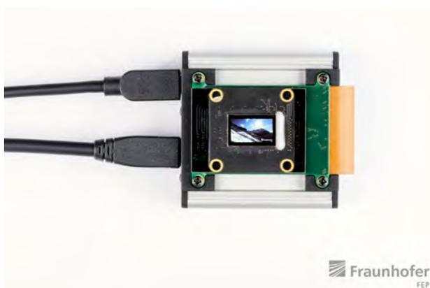
**Abbildung 2: Neues OLED-Mikrodisplay mit einer Auflösung von 1280 x 720 Pixel**
