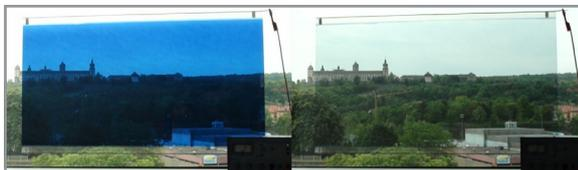
**Abb. 3: Lichtdurchlässigkeit je nach Bedarf einstellen: elektrochrome Folie im dunklen (links) und hellen Zustand (rechts)**
