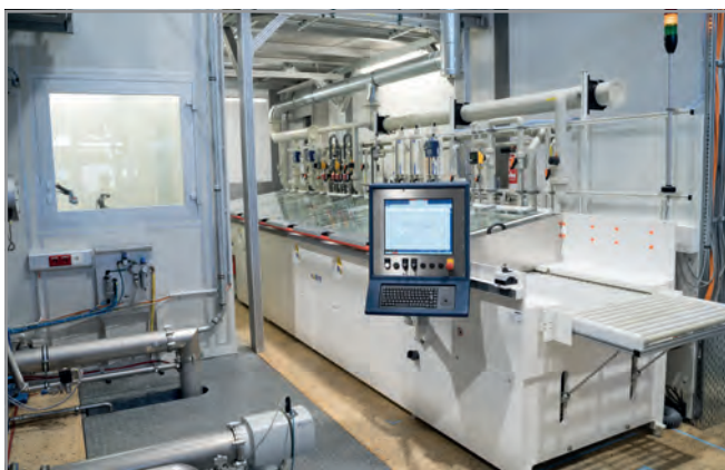
Abb. 1: Ultraschall-Nassreinigungsstrecke für Ultradünnglas vor der Beschichtung
