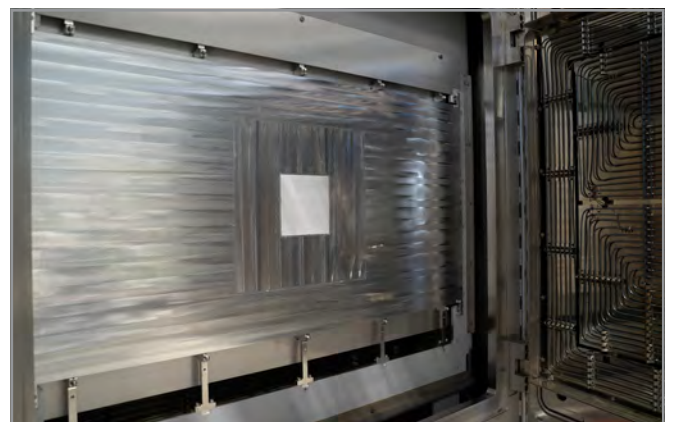
Abb. 2: Beispiel eines elektrostatischen Chucks zur Halterung des Ultradünnglases während der Beschichtung
