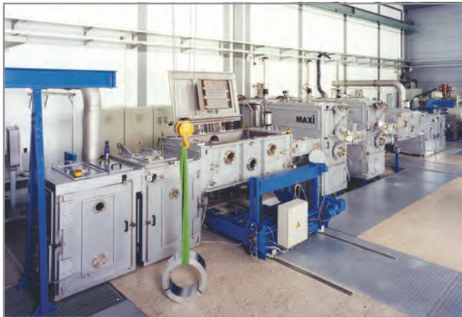
**In-line Vakuum-Beschichtungsanlage für Platten und metallische Bänder – MAXI**
