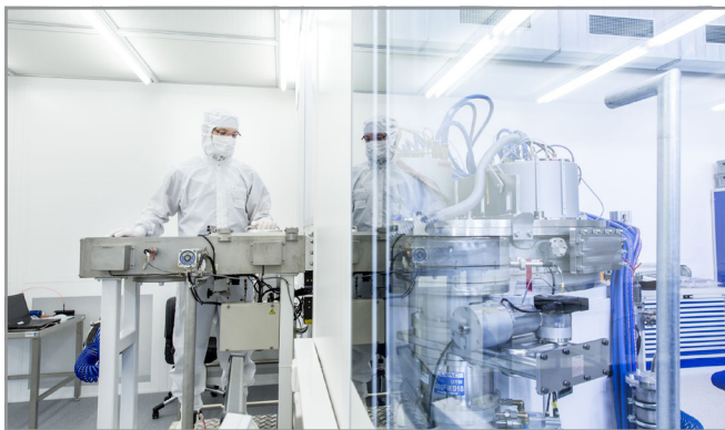
Clusteranlagen des Fraunhofer FEP für Puls-Magnetron-Sputterprozesse
