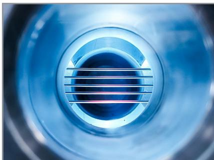
**In einem Mikrowellenplasma wird CO<sub>2</sub> in O<sub>2</sub> und CO gespalten. Das O<sub>2</sub> kann über eine Hohlfasermembran abgetrennt werden. Das CO kann dann mit grünem H<sub>2</sub> zu werthaltigen Produkten umgesetzt werden.**
