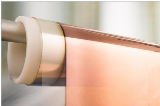
**Mittels Elektronenstrahlverdampfung mit Kupfer beschichtete Kunststoffolie zur Verwendung als Metall-Polymer-Stromkollektor (composite current collector) für Batteriezellen**
