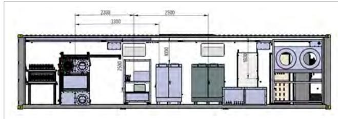
Mobiler Teststand zur Elektronenstrahlbehandlung von Abgasen und Abwässern sowie zur plasmachemischen Synthese TABEA
