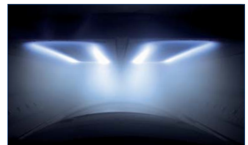
Beschichtungsprozess mit einem Plasma (hier: Magnetronspuiten)
