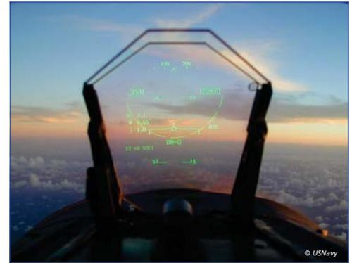
Head-up Display im Cockpit eines Flugzeuges
